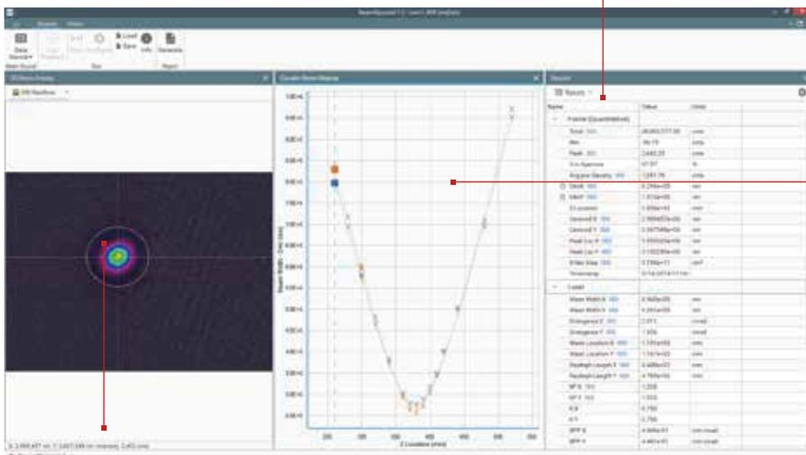
ある測定におけるビーム幅と位置の関係。いくつかのポイントを測定すると推定した曲線を計算。精度を上げるISO11146の手順に従って、ビームウエスト領域での測定頻度を2倍にするためにこのカーブを使用。X軸とY軸は個々のポイントで測定され、実線は測定ポイントにたいしてのビーム伝播方程式の近似双曲線。M2とその他のレーザのパラメータはデータのスムージングによって得られた近似双曲線から算出される。
