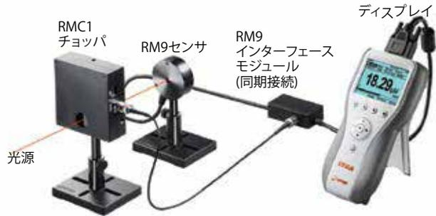
RM9シリーズ・ラジオメータシステムは、RM9センサとRMC1チョッパで構成されています。超低出力レベルのCWレーザ又はCW光に近い光源のパワー測定に最適です。アンプでノイズを最小限に低減しています。RM9センサにはRMC1チョッパまたはチョッピング周波数18Hzに対応するチョッパが必要です。18Hzでチョッピングされた信号はセンサで受光され、ディスプレイやPCインターフェースで測定値が表示されます。チョッパはどの位置に設置しても問題ありませんが、光源に近い位置に設置することをお勧めします。
